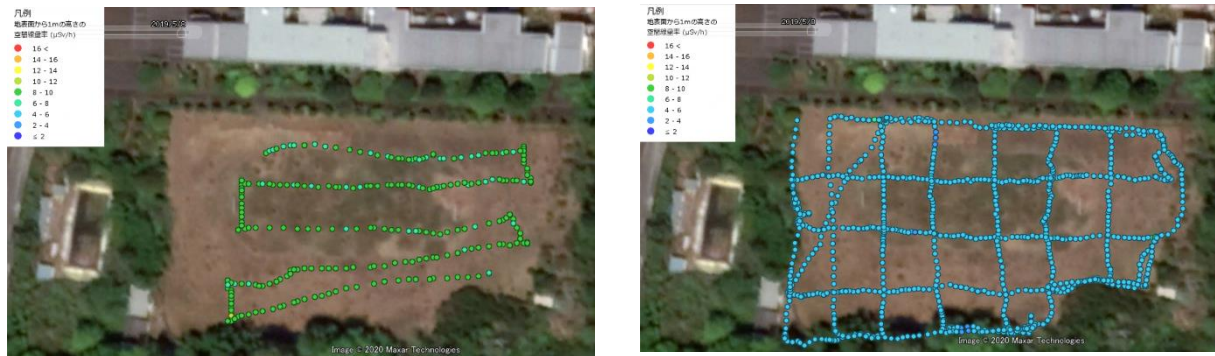
図5.2 バックパックとUAVの両方の手法を使って、立ち入り可能な地域で実施した現場測定（補正していない未加工データ）の例：高度10mで飛行するUAVシステム（ガイガーミュラーカウンター）を用いて得られたデータ地点（左側）。検出器が高度1mで設置した検出器で、地域全体を踏査するバックパックシステム（CsI分光計）を用いて得たデータ地点（右側）。（提供：福島県）
