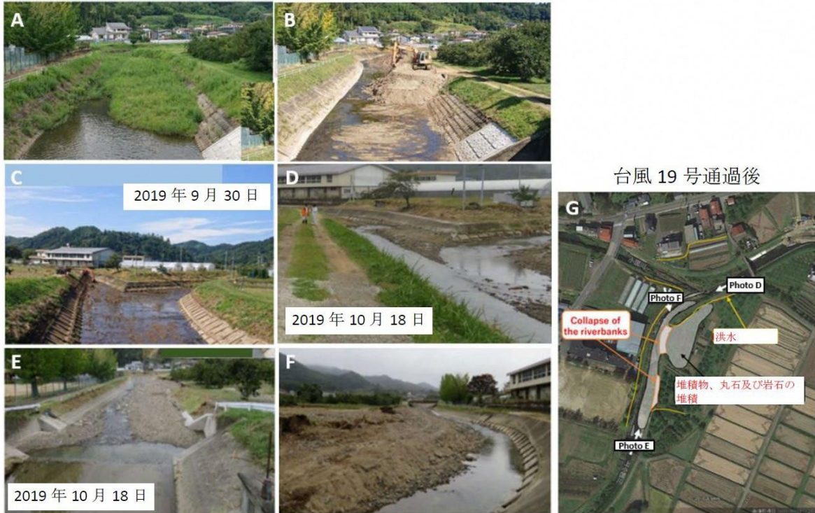
図 3.14 2019 年の上小国川における掘削工事（2019 年 9 月）と台風 19 号（2019 年 10 月 12 日～13 日）の前後の写真。写真 A は掘削前（2019 年 8 月 27 日）、写真 B は掘削後（2019 年 9 月 30 日）に撮影されたもの。写真 C（2019 年 9 月 30 日）は、掘削工事後、台風 19 号の通過前に撮影されたもの。写真 D～G は、台風 19 号の通過後（2019 年 10 月 18 日）に撮影されたもの。写真 D は写真 C とほぼ同じ場所で撮影（提供：福島県）。
