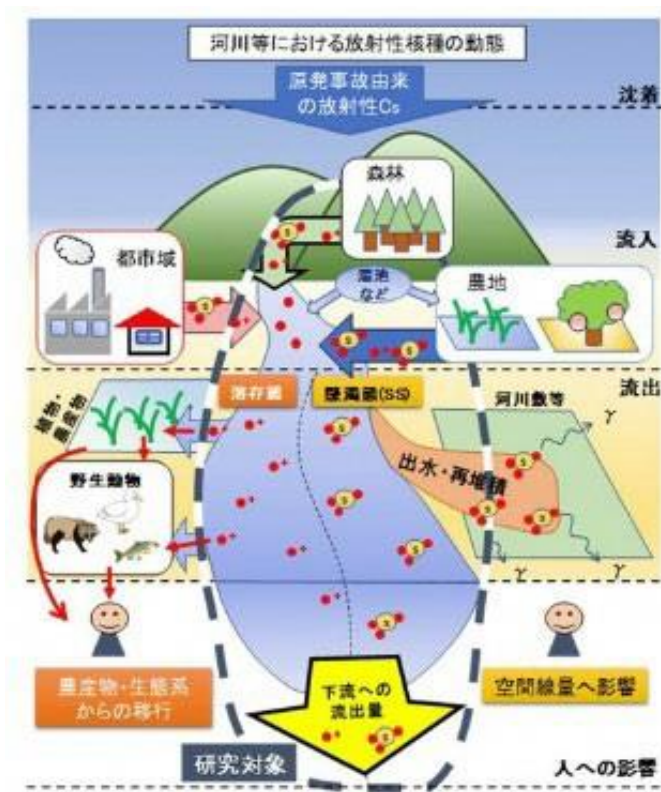
図 3.1 集水域を介した放射性セシウムの移行及び陸域との相互作用の概要図（提供：福島県）
